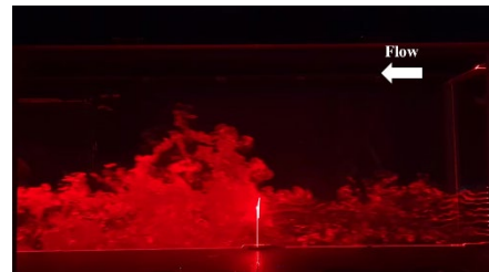
Fig. 15 不安定成層条件+境界層模擬の場合におけるディスク近傍の流れパターン
