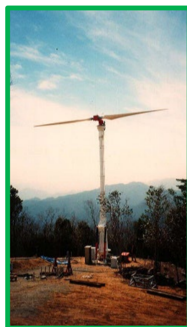
機技研風車15kW 2翅,Up Windパッシブピッチ・ヨー制御 山岳試験
