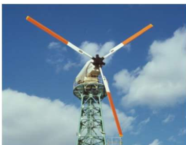
三菱重工1号機 ダウンウインド風車, 40kW, 1980年
